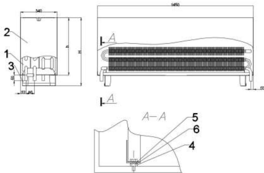
**Рис2.** Конвектор типа КПВК с кожухом для однотрубной системы проходной
